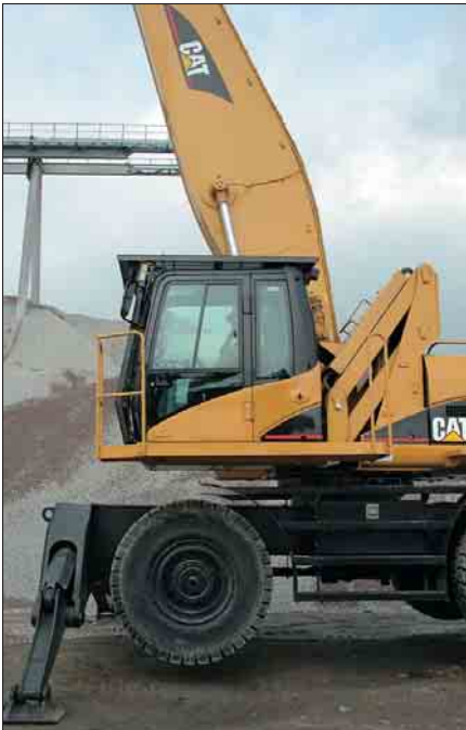
Ala-asento. Ala-asentoa käytetään siirtoajossa ja koneen kuljetuksissa.
