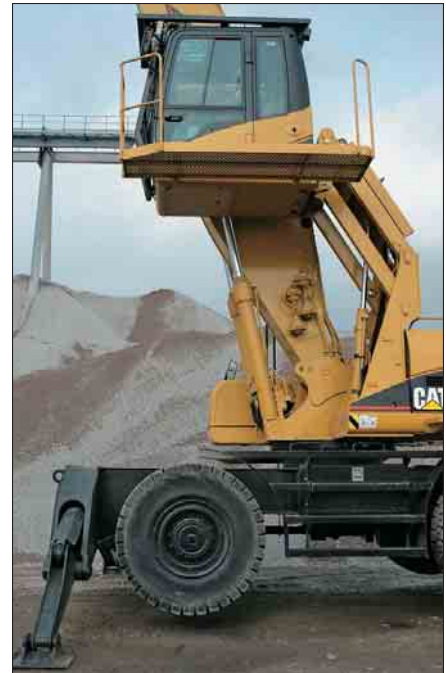
Yläasento. Yläasennossa ohjaamo nousee 2600 mm ylöspäin. Yläasento takaa optimaalisen näkyvyyden esimerkiksi romunkäsittelyssä ja satamatyöskentelyssä. Ohjaamo voidaan säätää portaattomasti mille korkeudelle hyvänsä ala- ja yläasennon väliin.
