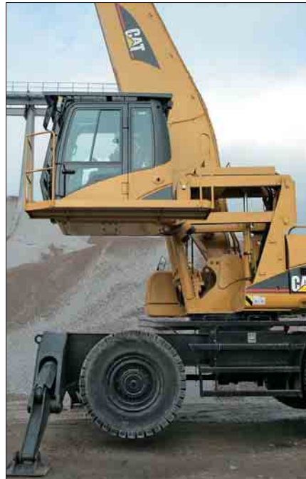
Keskiasento. Keskiasennossa ohjaamo siirtyy ala-asentoon verrattuna 500 mm eteenpäin näkyvyyden parantamiseksi.
